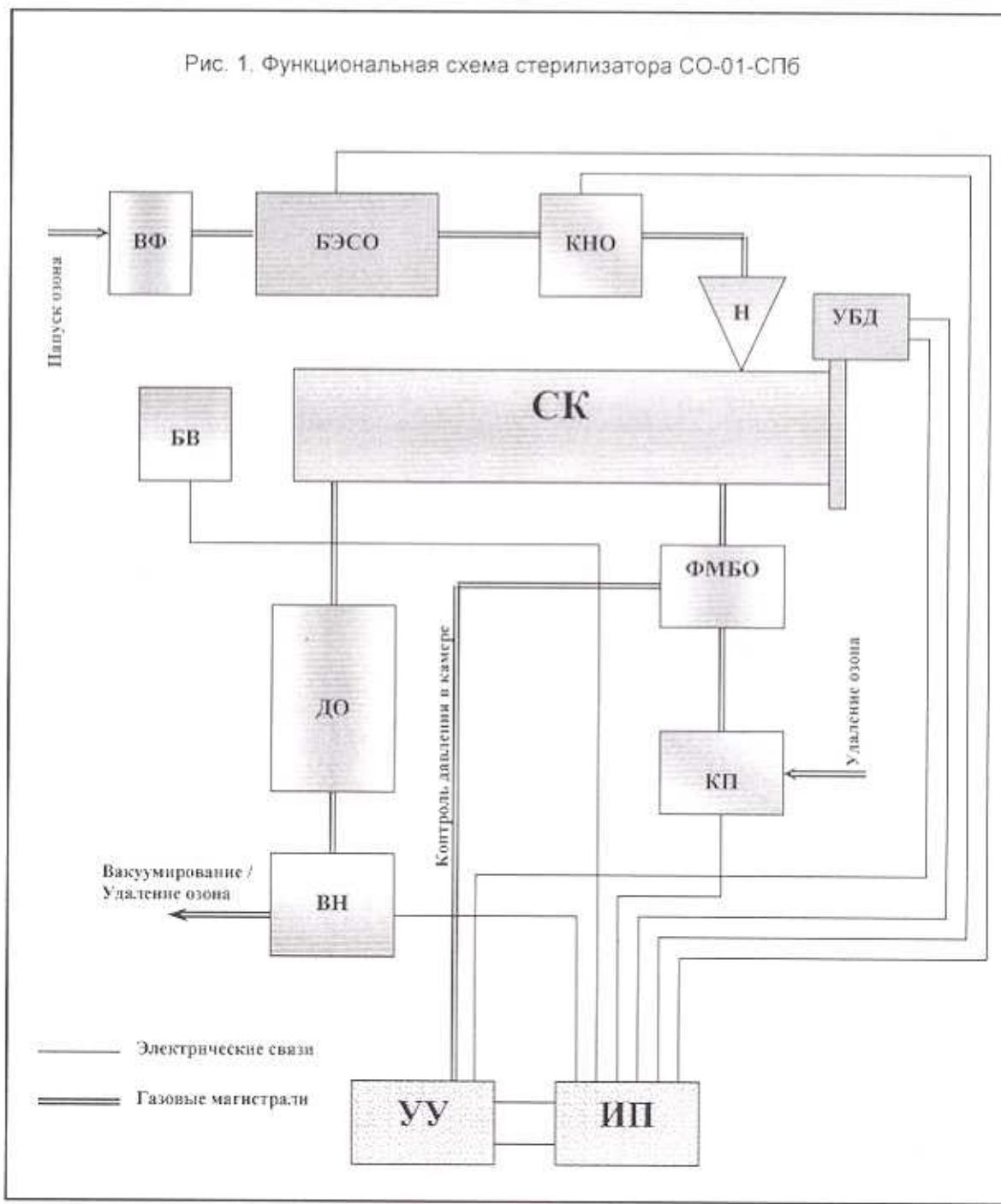
При включении стерилизатора устройство управления проводит ряд проверок его функционального состояния и разрешает запуск стерилизационного цикла, если дверь камеры закрыта и неполадок не обнаружено.
